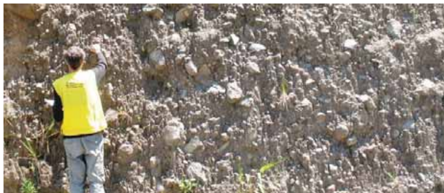
Depósitos de un coluvión. Se observan grandes bloques angulares y subangulares (de composición dacítica) y una distribución granulométrica que indica una mala clasificación del depósito; la ausencia de estratificación es una característica común en todos los coluviones. Hoja 1:50.000 NIV-F2, San Miguel de Bolívar
