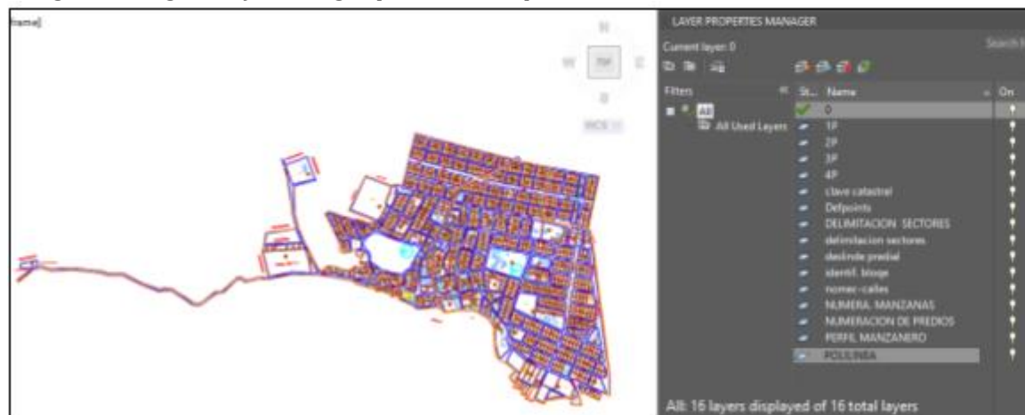
Imagen 3.- Segundo filtro: agrupación de capas en un solo archivo.
