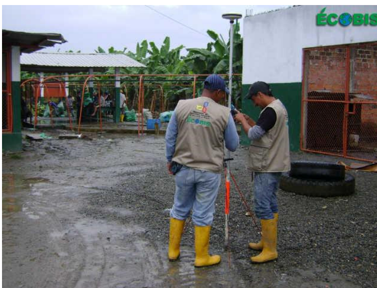
Foto 1.- Equipo de campo (brigadas de barrido predial) ubicando la estación base DGPS para realizar linderación perimetral.
