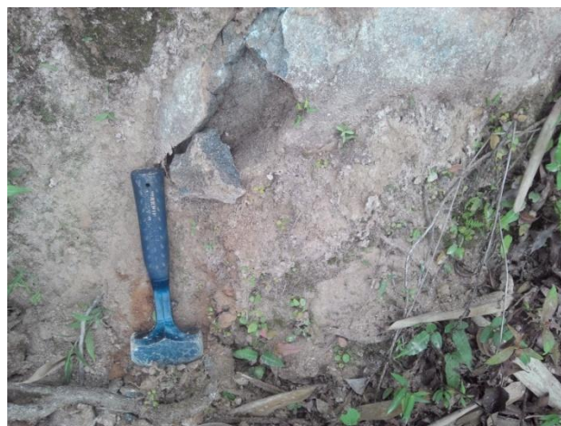
Fotos 12 y 13. Interfluvio de cimas estrechas. Detalle del macizo rocoso de granito muy alterado. Sector Cerro Repén. 29/11/2014.
