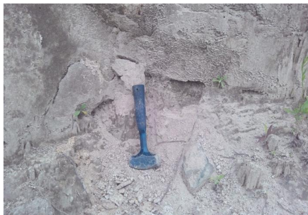
Fotos 3 y 4. Vertiente rectilínea. Detalle del macizo rocoso de granito muy alterado. Sector Cerro Chamisal. 29/11/2014.
