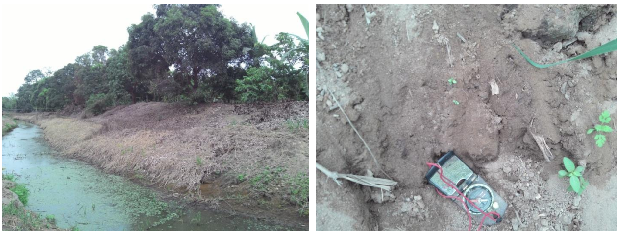
Fotos 7 y 8. Dique o banco aluvial. Vista general y detalle del depósito: arena, limo y arcilla. Sector Cooperativa Tinoco. 02/11/2014.
