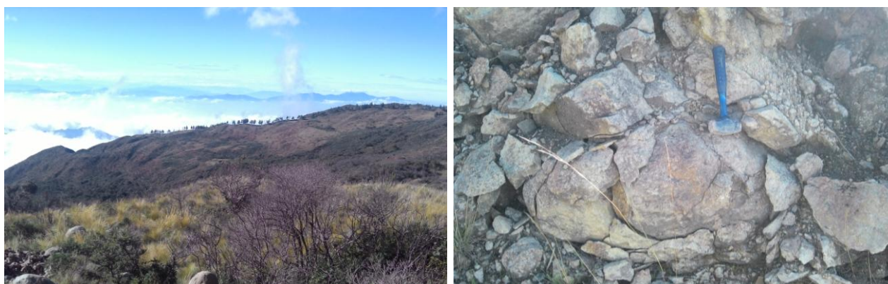
Fotos 5 y 6. Vertiente heterogénea con fuerte disección. Vista general y detalle de las tobas meteorizadas de la Fm. Saraguro. Sector cerro Chillacocho 02/12/2014.
