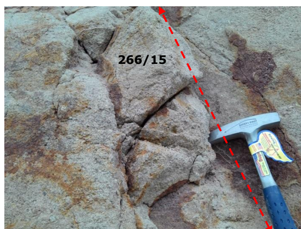
Fotos 66 y 67. Vertiente de chevron. Vista general (izquierda). Detalle del macizo rocoso con la dirección del azimut del diaclasado principal (derecha). Sector sureste cerro Rutuna. 07/04/2014.
