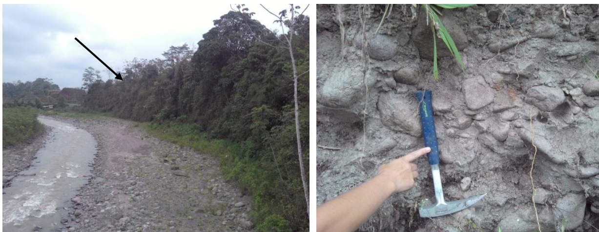
Fotos 10 y 11. Vertiente o abrupto de terraza. Vista general y detalle del depósito superficial en matriz areno limoso de color gris. Sector Cumandá. 01/11/2014.
