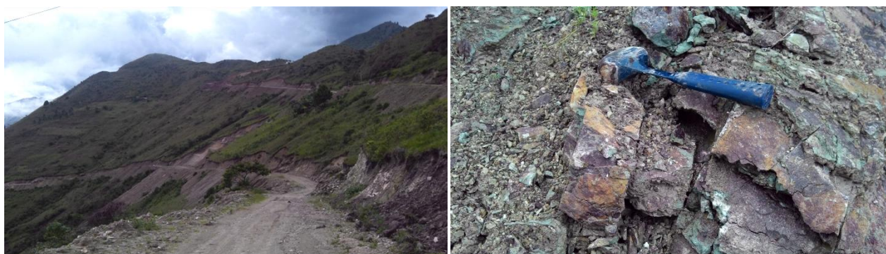
Fotos 3 y 4. Vertiente rectilínea con fuerte disección y detalle del macizo rocoso en rocas de la Formación Saraguro. Sector Cocha Loma. 26/05/2014.
