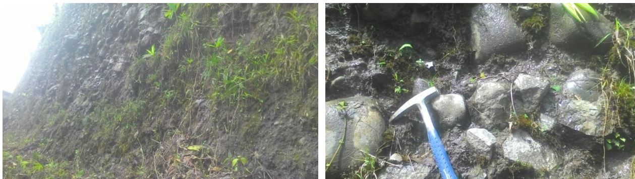
Fotos 7 y 8. Terraza media del río Upano a su paso por Macas. Vista de un afloramiento de la terraza (izquierda) y detalle del depósito, formado por bloques y gravas en matriz arenosa de coloración negra (derecha). Sector Macas. 08/08/2014.
