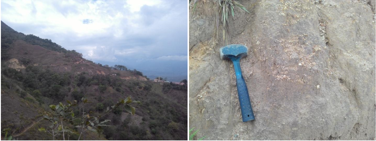
Fotos 13 y 14: Vertiente heterogénea con fuerte disección. Vista general (izquierda) y detalle del macizo rocoso (derecha). Fm. Grupo Tahuín. Sector San Roque. 25/11/2014.
