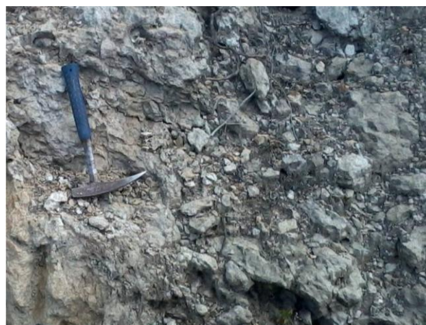
Fotos 15 y 16. Coluvión antiguo. Vista general y detalle del depósito superficial: mezcla heterogénea de bloques de diferente tamaño empastados en una matriz limosa. Sector La Cuchilla. 04/12/2014.
