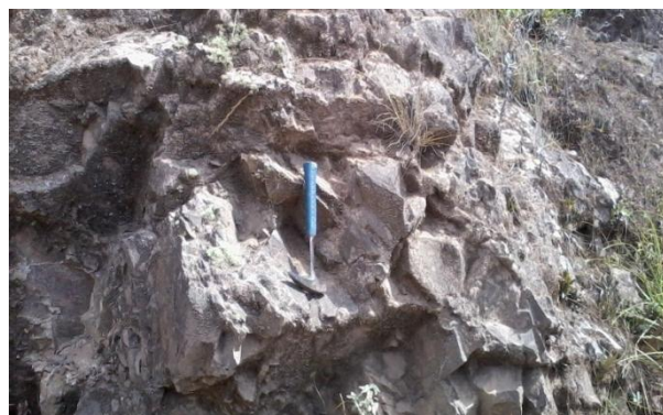
Fotos 30 y 31. Superficie inclinada. Vista general y detalle del macizo rocoso, toba riolítica de la Fm. Tarqui. Sector Patococha. 04/12/2014.
