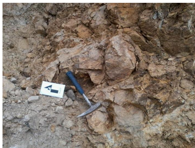
Fotos 13 y 14. Vertiente heterogénea con fuerte disección. Vista general y detalle del macizo rocoso, toba volcánica de la Fm. Saraguro. Sector Plancha. 04/12/2014.
