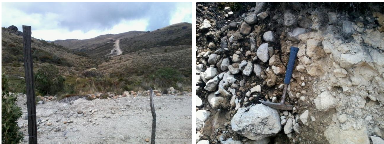
Foto 20 y 21. Depósito glaciar modelado por acción fluvial. Vista general y detalle del depósito: bloques y gravas en matriz de grano fino, con ocasionales niveles de arenas. Sector quebrada Narihuiña. 04/12/2014.
