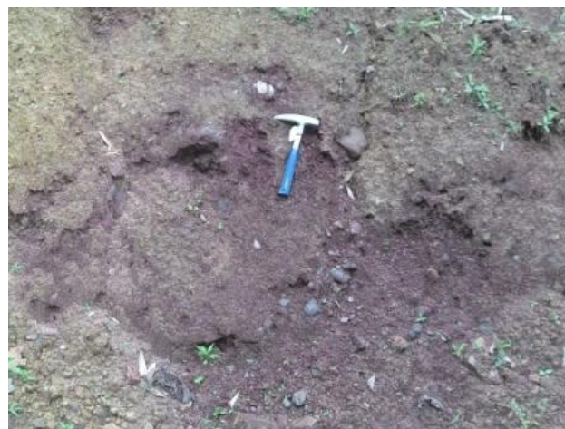
Fotos 22 y 23. Coluvión antiguo. Vista general y detalle del depósito: bloque redondeado, grava, arena y limo. Sector Cooperativa Agrícola Chictoa. 20/10/2014.
