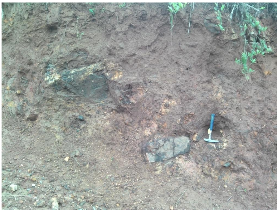
Foto 11. Depósito de deslizamiento, masa deslizada. Detalle del depósito superficial, bloques angulares, grava, en matriz limo-arcillosa. Sector Curicaca. 21/01/2015.
