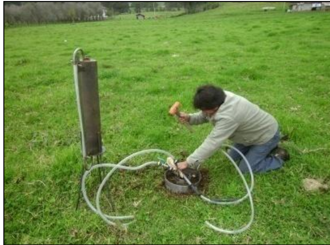
Foto 2.1. Proceso de instalación del infiltrómetro de doble anillo de carga constante
